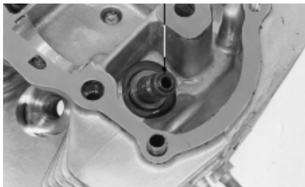
RETENTOR HASTE DE VÁLVULAS
