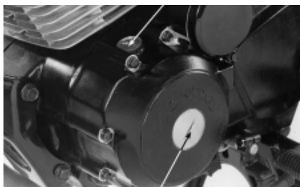
TAMPA DO ORIFÍCIO DA ÁRVORE DE MANIVELAS
