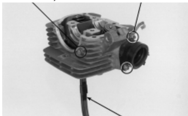
TENSOR DA CORRENTE DE COMANDO
