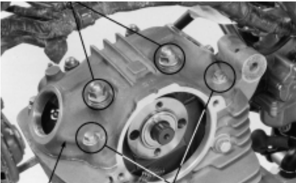
TAMPA DO CABEÇOTE PARAFUSOS
